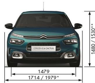
\*Breite des Fahrzeugs / Breite mit ausgeklappten Außenspiegeln.
